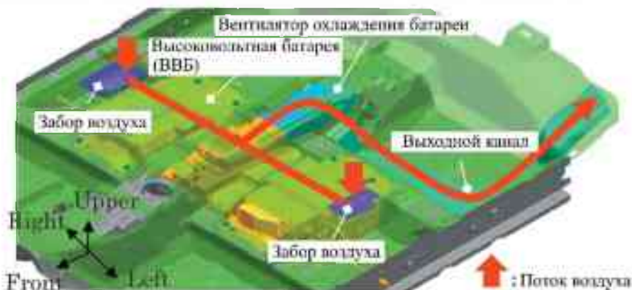
Рис.3 Архитектура системы охлаждения аккумулятора
