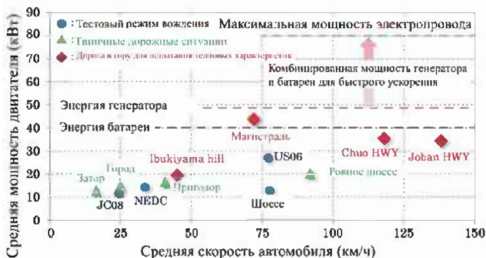
Рис. 7 Баланс энергопотребления и выработки электроэнергии
